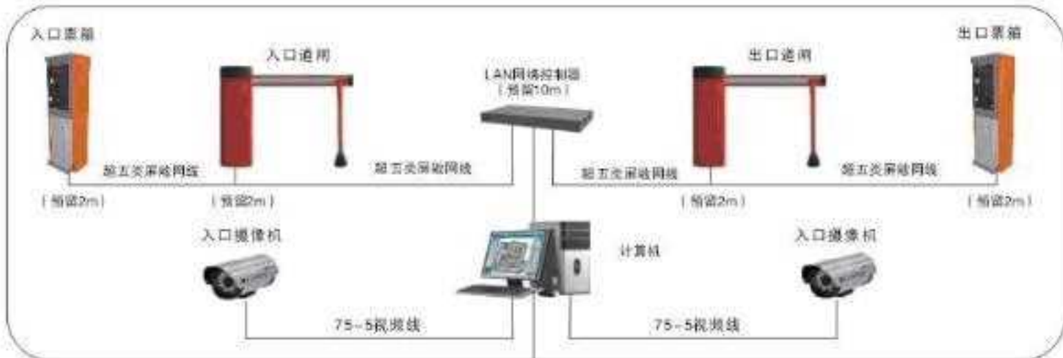
两进两出停车场系统接线示意图
