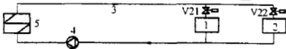
图 7-2-2 热用户与热网直接连接
