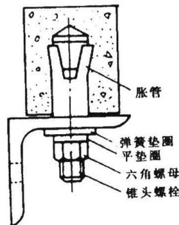
1、按风管的中心线，找出吊杆敷设位置，单吊杆在风管中的中心线上，双吊杆可以按托盘的螺孔间距或风管的中心线对称安装。
