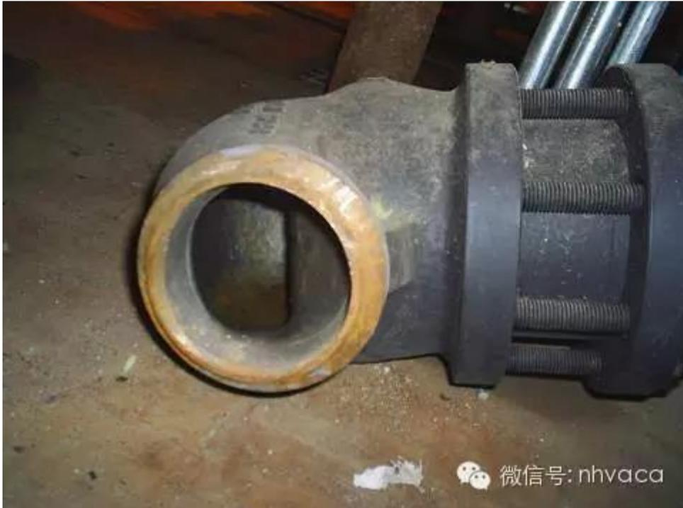
在#1 机组中、低压管道水压试验过程，发现较多管道法兰连接处存在漏水现象，除有纸垫不符合要求外，关键问题还是法兰螺栓没有上紧。上法兰时螺丝须对称紧螺栓，全部上完后须用扳手重新紧一遍。所有垫片均采用石墨缠绕垫。
